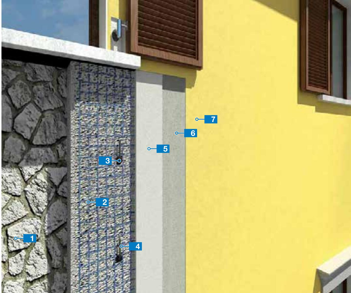
Sistema completo per il consolidamento di murature meccanicamente deboli, con intonaco strutturale "armato"
