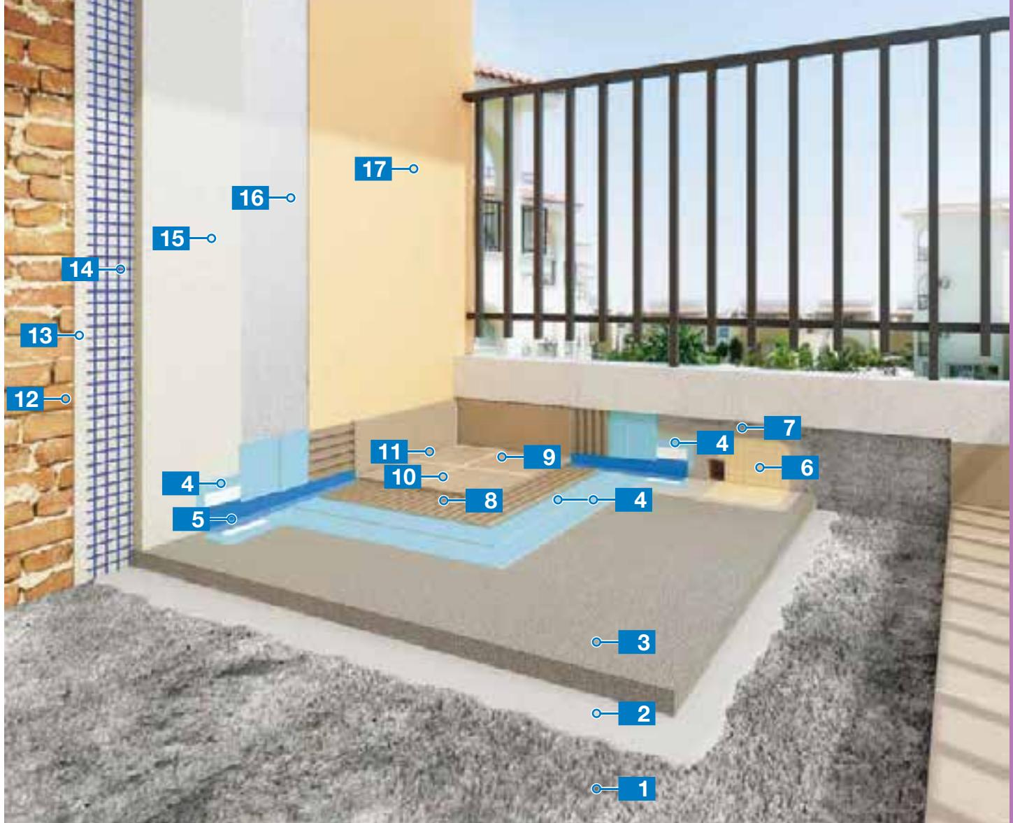
Sistema rapido per l'impermeabilizzazione e la posa di ceramica su balconi e rinforzo di edifici storici con sistemi esenti da cemento e finitura idrorepellente
