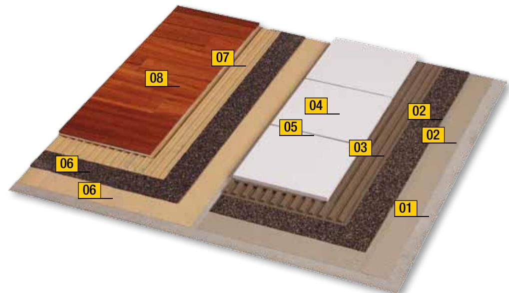
Sistēma **hidroizolācijas izveidei** un **fližu instalēšanai** uz esošiem terašu fližu klājumiem
